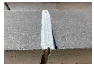
面外曲げ試験 試験後試験体
